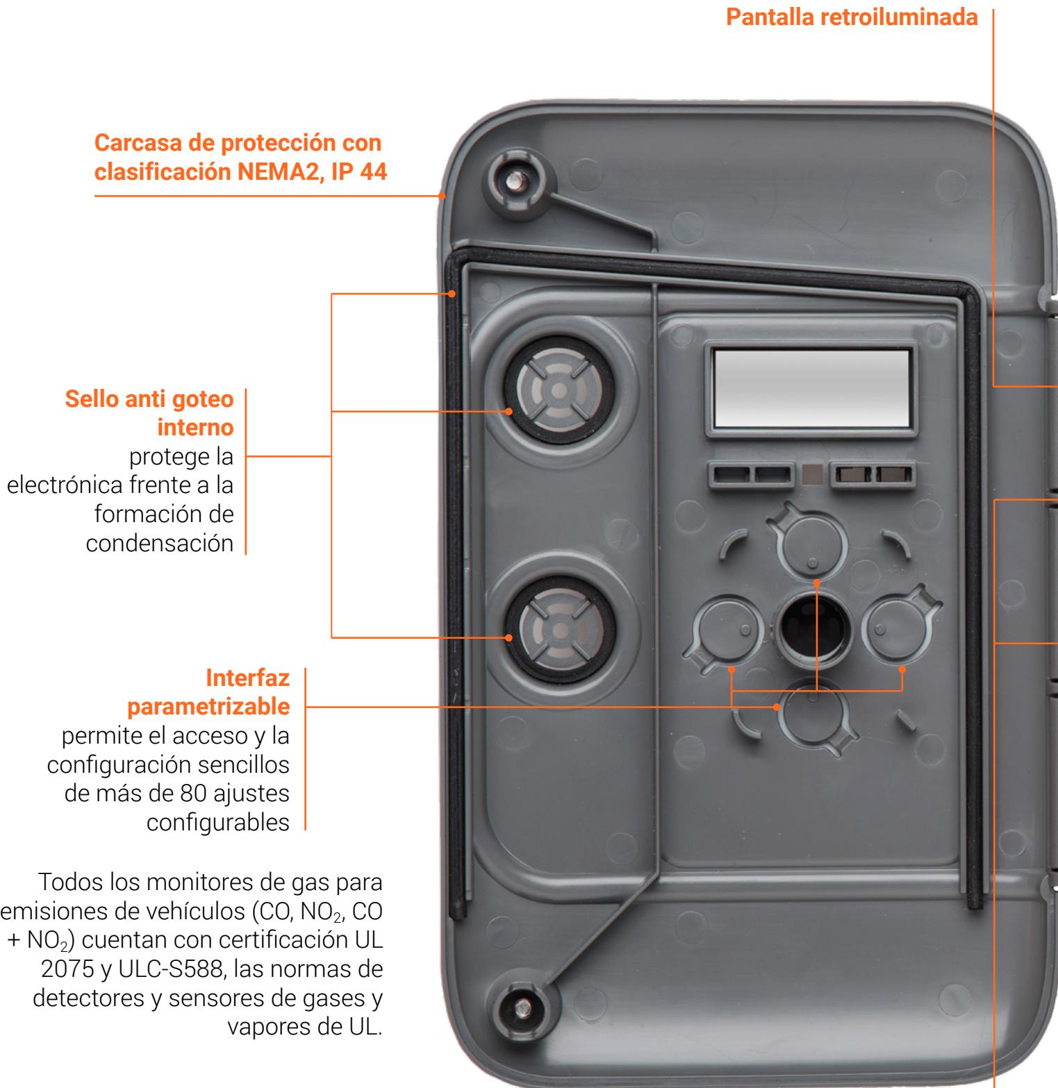
**Carcasa de protección con clasificación NEMA2, IP 44**
