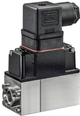
22WDP 系列水压差传感器用于 HVAC 系统中的压差测量。产品应用选型时，需注意测量压差、过压压差和管道压力均应在产品的参数要求范围内。超出参数要求范围，将会导致产品无法正常工作。具体产品参数要求如下表所示：
