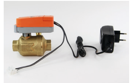
Drukonaafhankelijke regelkogelkraan PIQCV met 1.5 m lange aansluitkabel voor afgifte units in stadsverwarmingsprojecten. Met stekkeradapter en klemmen voor aansluiting op een ruimtethermostaat.
