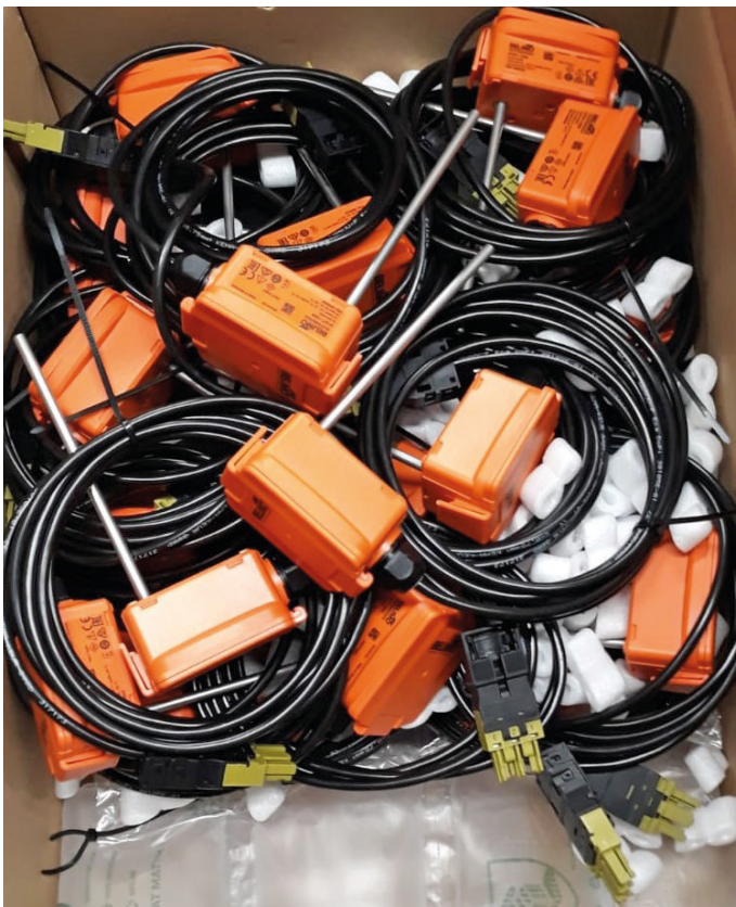
Kanaal-/dompeltemperatuursensor met 2 m lange aansluitkabel en Wago-connector.
