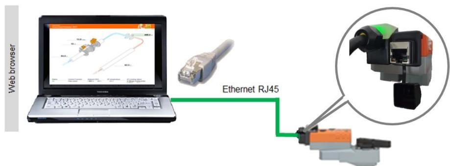
Anmerkung: Der Antrieb muss mit Spannung versorgt sein
