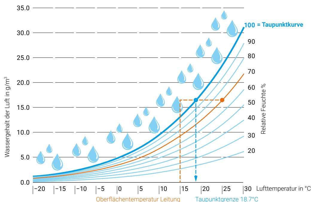
Wird die Taupunktkurve überschritten, bildet sich an kalten Oberflächen Kondenswasser. Daher ist eine Isolierung der Leitung erforderlich, um Kondenswasserbildung zu verhindern. Siehe nachfolgendes Vergleichsbeispiel.
