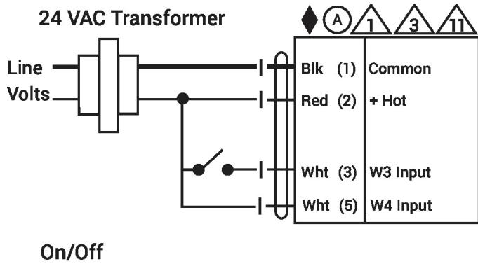
**Electrical installation****Wiring diagrams**
