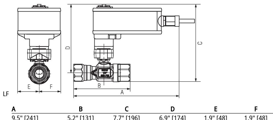
On/Off (Encendido/Apagado), Muelle de retorno, 120 V
