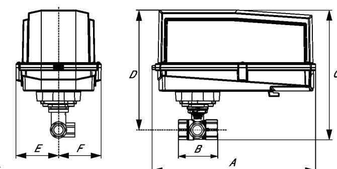
On/Off (Encendido/Apagado), Muelle de retorno, 100...240 V
