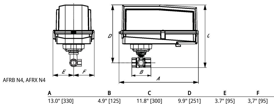
On/Off (Encendido/Apagado), Muelle de retorno, 24 V
