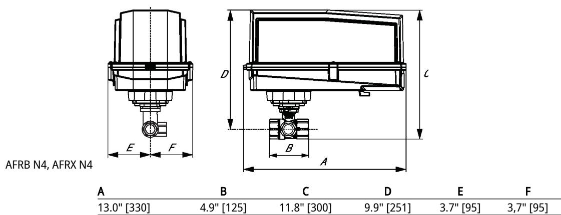
On/Off (Encendido/Apagado), Muelle de retorno, 24...240 V
