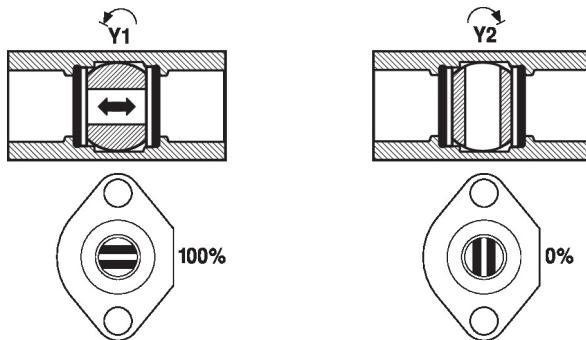
**Ajuste de flujo** El ángulo de giro del actuador puede modificarse en incrementos de 2.5° mediante un clip. Este se utiliza para ajustar el valor kvs (flujo máximo de la válvula). Extraiga la pinza de tope y colóquela en la posición deseada. Despues de cada cambio del ajuste del flujo mediante la pinza de tope, debe activarse una adaptación en los actuadores modulantes.
