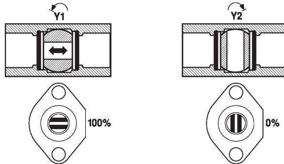
**Ajuste de flujo** El ángulo de giro del actuador puede modificarse en incrementos de 2.5° mediante un clip. Este se utiliza para ajustar el valor kvs (flujo máximo de la válvula). Extraiga la pinza de tope y colóquela en la posición deseada. Después de cada cambio del ajuste del flujo mediante la pinza de tope, debe activarse una adaptación en los actuadores modulantes.
