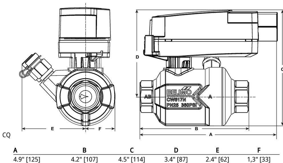
On/Off (Encendido/Apagado), Función de protección eléctrica a prueba de fallas, 24 V
