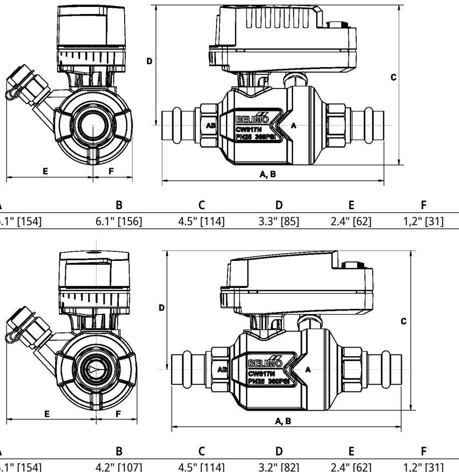
On/Off (Encendido/Apagado), Función de protección eléctrica a prueba de fallas, 24 V
