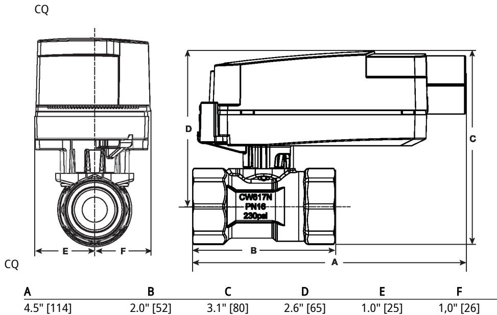
Proporcional, Función de protección eléctrica a prueba de fallas, 24 V
