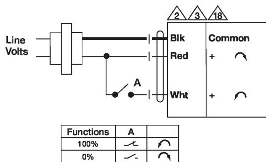
Transformador punto flotante AC 24 V
