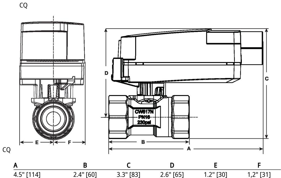
On/Off (Encendido/Apagado), Función de protección eléctrica a prueba de fallas, 100...240 V
