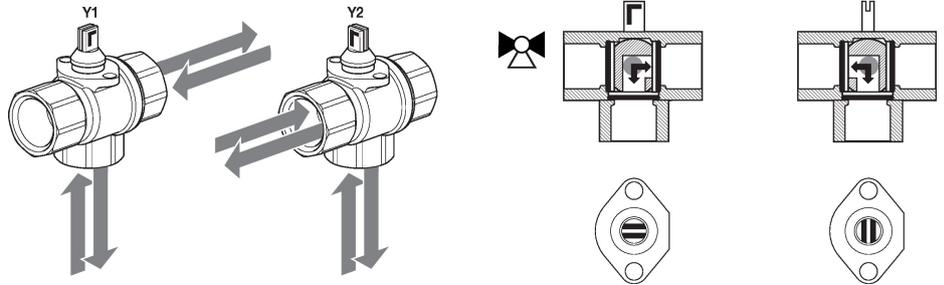
**Modo de funcionamiento** La válvula de zona para conmutación se ajusta mediante un actuador giratorio. El actuador giratorio se controla mediante una señal de apertura/cierre.
