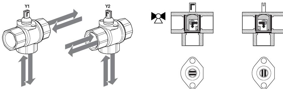
**Modo de funcionamiento** La válvula de zona para conmutación se ajusta mediante un actuador giratorio. El actuador giratorio se controla mediante una señal de apertura/cierre.
