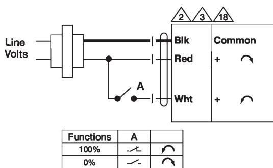
Transformador punto flotante AC 24 V
