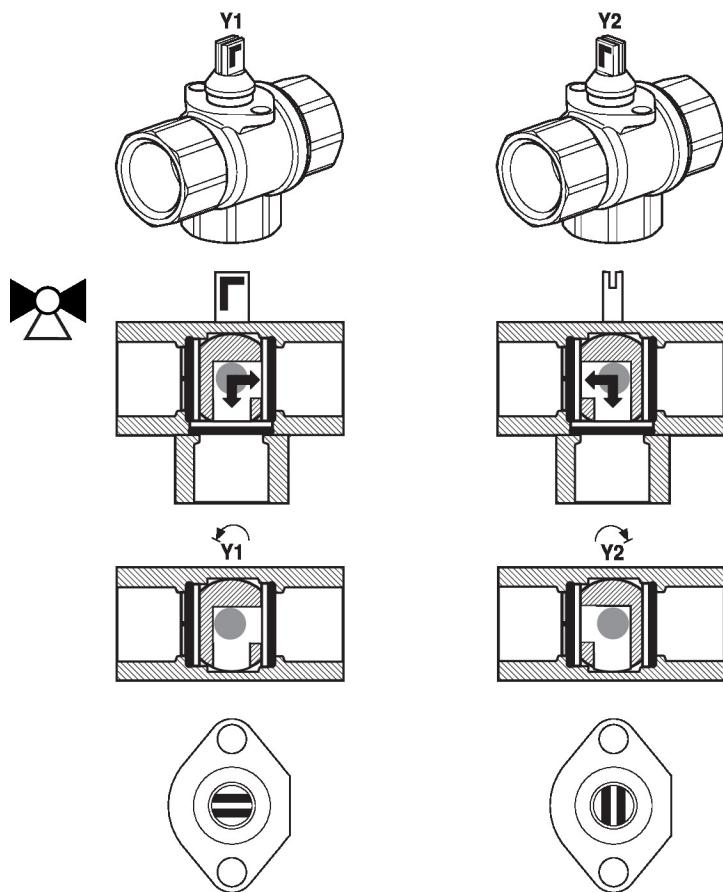
**Ajuste de flujo** Debe retirarse la pinza de tope en el actuador para obtener un ángulo de giro de 90°, necesario para la funcionalidad de cambio de régimen.
