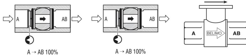
Les robinets à deux voies doivent être installées avec le disque en amont.
