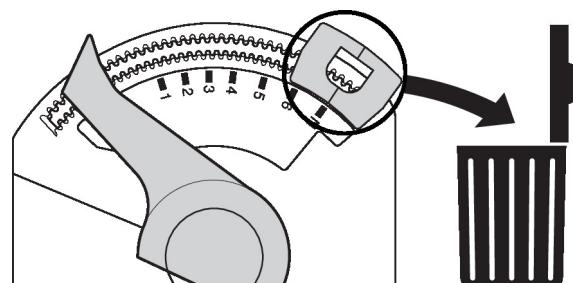
Retirer la butée d'arrêt à encliquer
