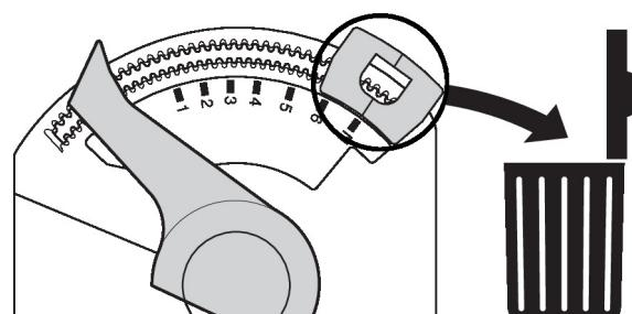
Retirer la butée d'arrêt à encliquer
