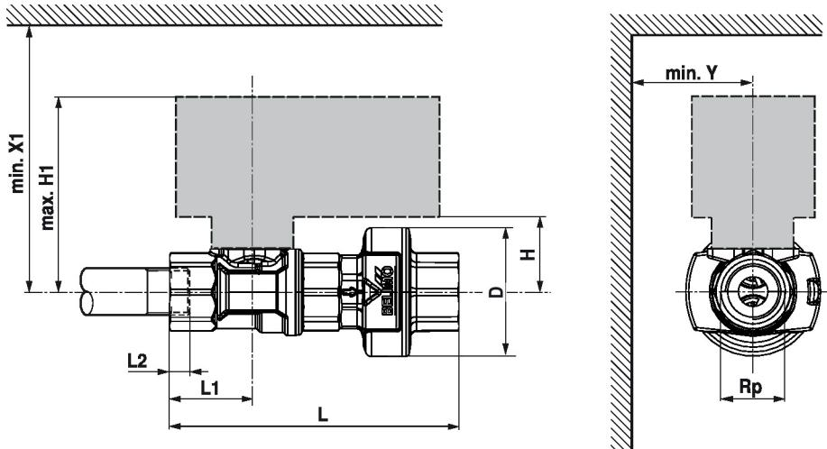
L2 : Profondeur de vissage maximale
