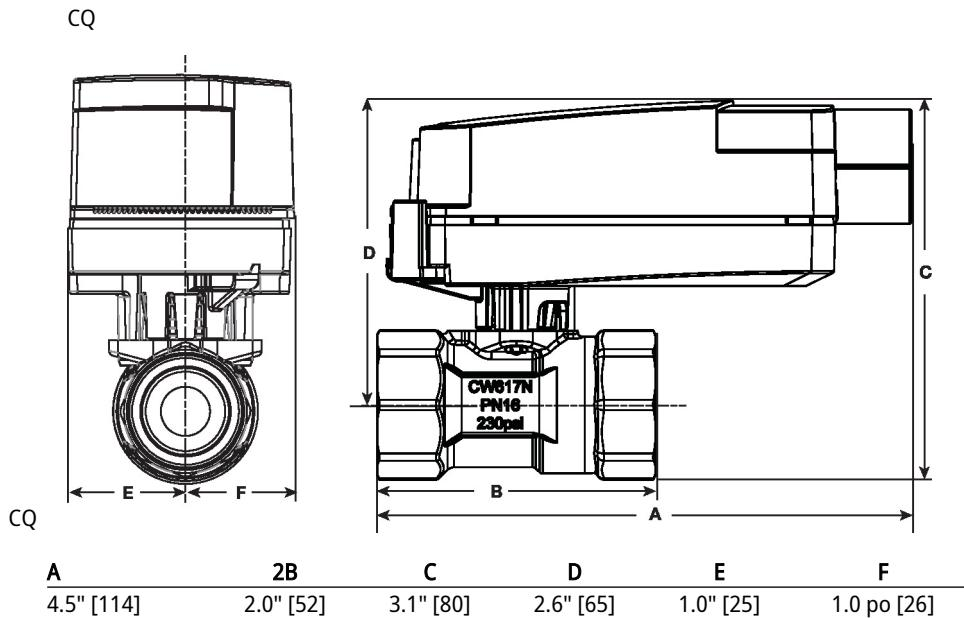
Modulant, Électricité à sûreté intégrée, 24 V
