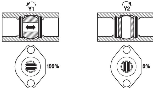
**Réglage de débit** L'angle de rotation du servomoteur est réglable, à l'aide d'une pince, par incrément de 2,5°. Cela sert à régler la valeur de kvs (débit maximal du robinet).
