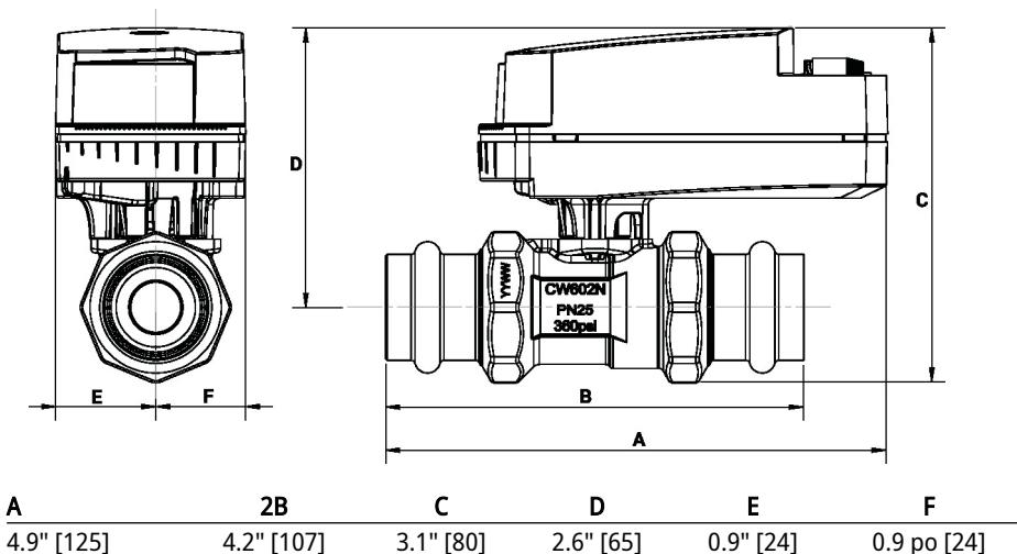
Modulant, Électricité à sûreté intégrée, 24 V
