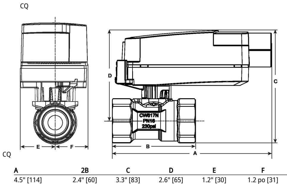
Modulant, Électricité à sûreté intégrée, 24 V
