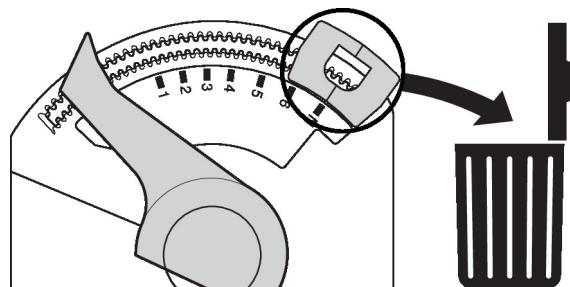
Retirer la butée d'arrêt à encliquer
