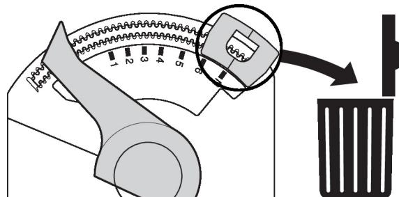
Retirer la butée d'arrêt à encliquer
