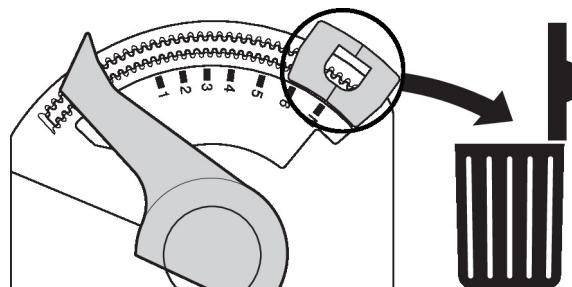
Retirer la butée d'arrêt à encliquer
