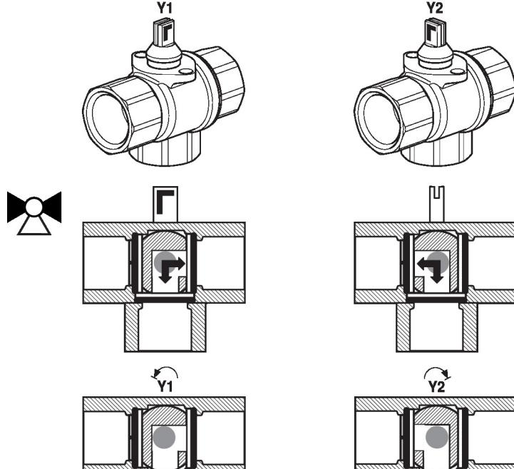
**Réglage de débit** Au niveau du servomoteur, la butée de fin de course encliquetable doit être retirée afin d'obtenir l'angle de rotation de 90° nécessaire à la fonctionnalité de commutation.
