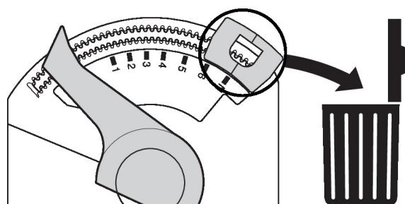
Retirer la butée d'arrêt à encliquer
