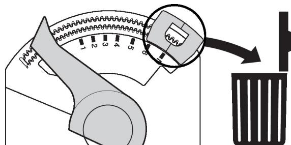
Retirer la butée d'arrêt à encliquer
