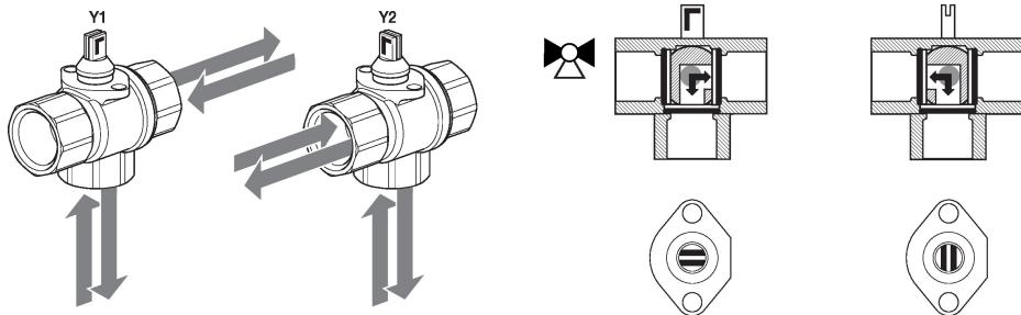
**Mode de fonctionnement** Le robinet de réglage par zone est réglé par un servomoteur rotatif. Le servomoteur rotatif est commandé par un signal tout ou rien.
