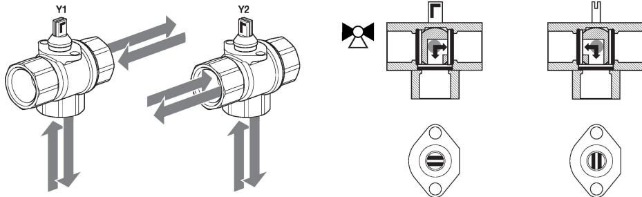
**Mode de fonctionnement** Le robinet de réglage par zone est réglé par un servomoteur rotatif. Le servomoteur rotatif est commandé par un signal tout ou rien.
