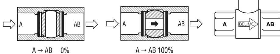
As válvulas de duas vias devem ser instaladas com o disco a montante.
