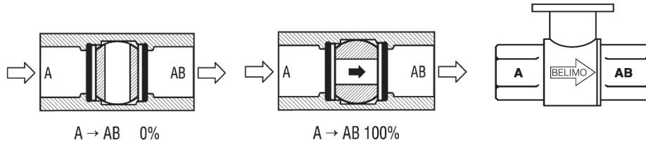
As válvulas de duas vias devem ser instaladas com o disco a montante.
