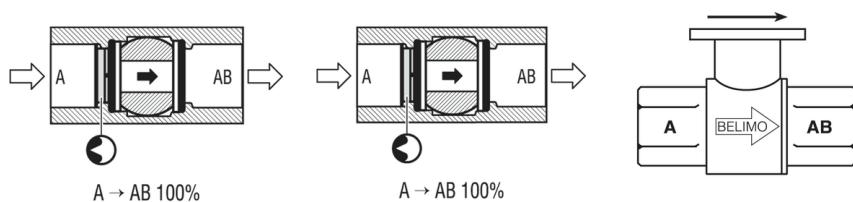
As válvulas de duas vias devem ser instaladas com o disco a montante.
