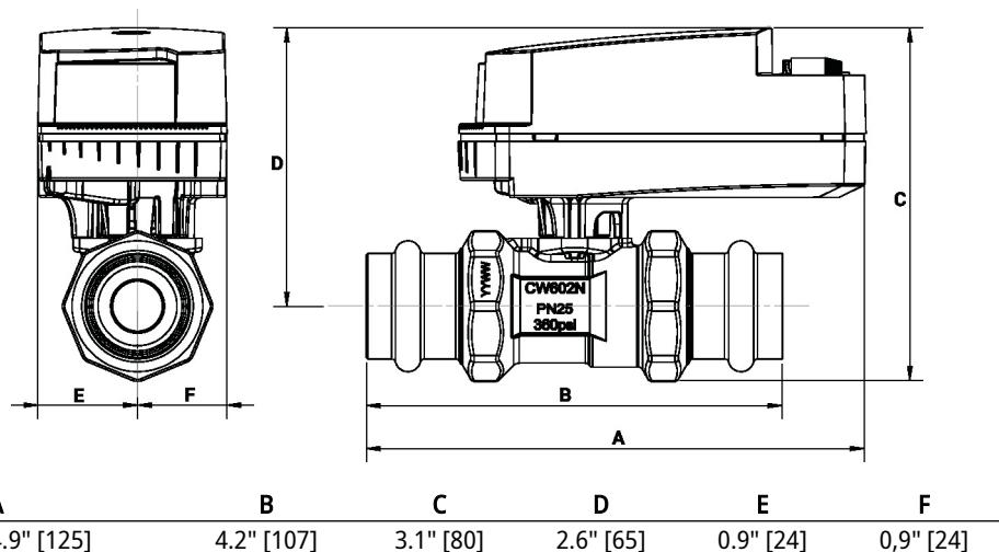
On/Off, Função de segurança elétrica, 24 V
