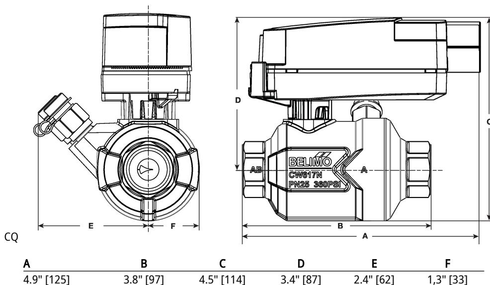
On/Off, Função de segurança elétrica, 24 V
