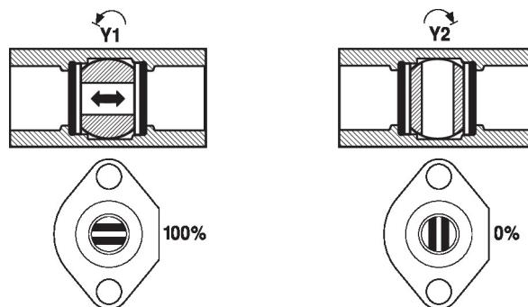
**Ajuste de fluxo** O ângulo de rotação do atuador pode ser alterado por um clipe em incrementos de 2,5°. Isso é usado para definir o valor kvs (vazão máxima da válvula).
