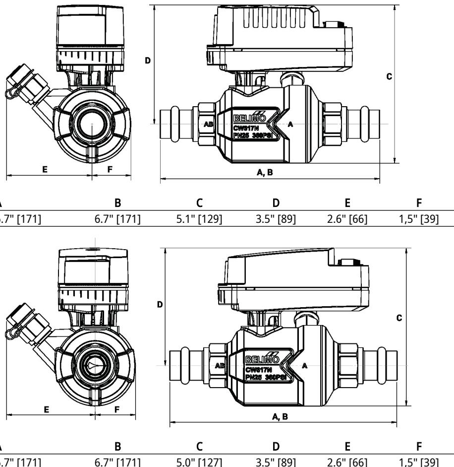
On/Off, Função de segurança elétrica, 24 V
