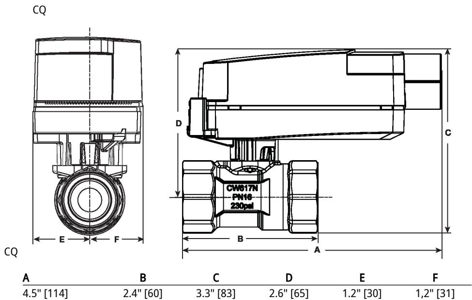
On/Off, Função de segurança elétrica, 24 V
