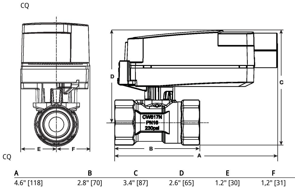
On/Off, Função de segurança elétrica, 24 V
