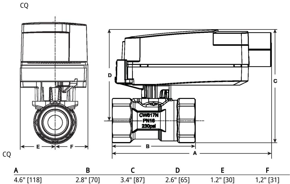
On/Off, Função de segurança elétrica, 24 V
