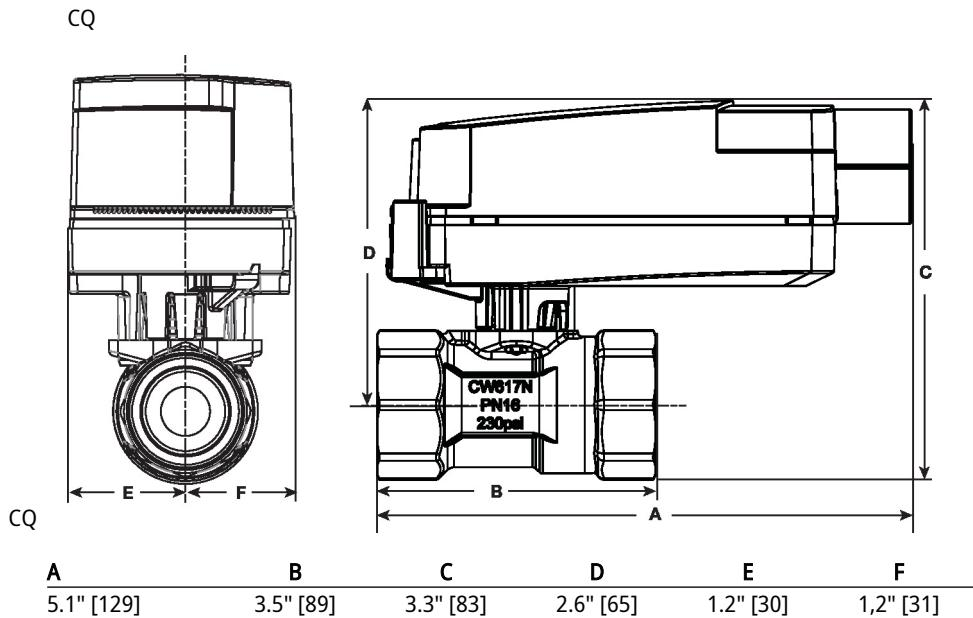
On/Off, Função de segurança elétrica, 24 V
