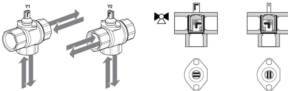
**Modo de operação** A válvula de zona de comutação é ajustada por um atuador rotativo. O atuador rotativo é controlado por um sinal de on/off.
