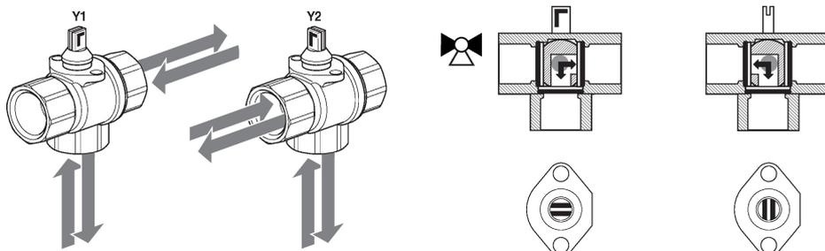
**Modo de operação** A válvula de zona de comutação é ajustada por um atuador rotativo. O atuador rotativo é controlado por um sinal de on/off.
