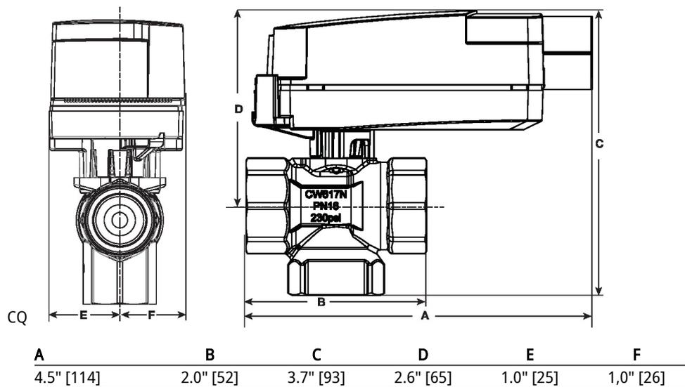
On/Off, Função de segurança elétrica, 24 V
