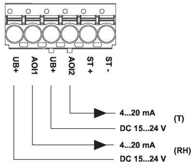
Korrekte Temperaturwerte sind nur verfügbar, wenn der Feuchte-Ausgang AO1 verbunden ist und beide Eingänge UB + angeschlossen sind.
