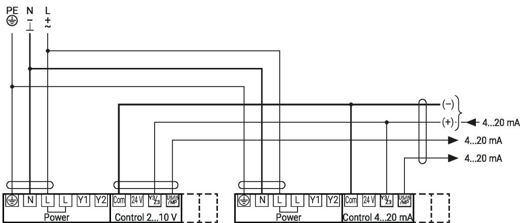
Anschluss BACnet MS/TP / Modbus RTU mit analoger Folgeschaltung
