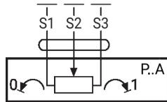
Empfehlung: Verdrahtung als Spannungsteiler
