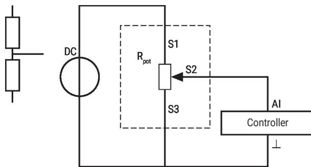
Wird das Potentiometer überwiegend im gleichen kleinen Winkelbereich betrieben, empfehlen wir die Verdrahtung als Spannungsteiler.
